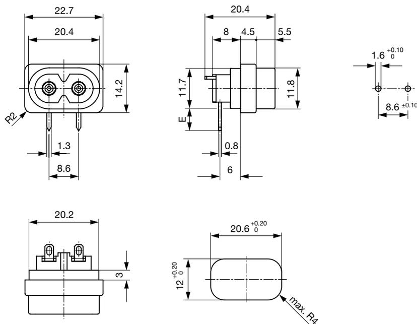
E = Leiterplattenanschluss standard (zusätzlicher Lötanschluss): 6.8 mm
